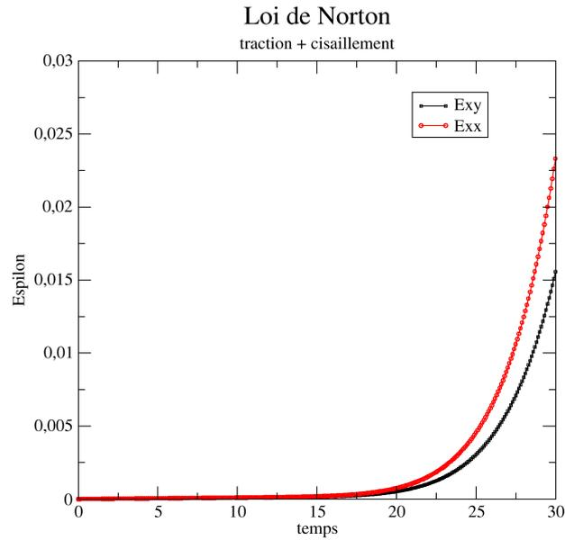
FIGURE 1 – Réponse d’une loi de NORTON à un essai de fluage en traction-cisaillement
