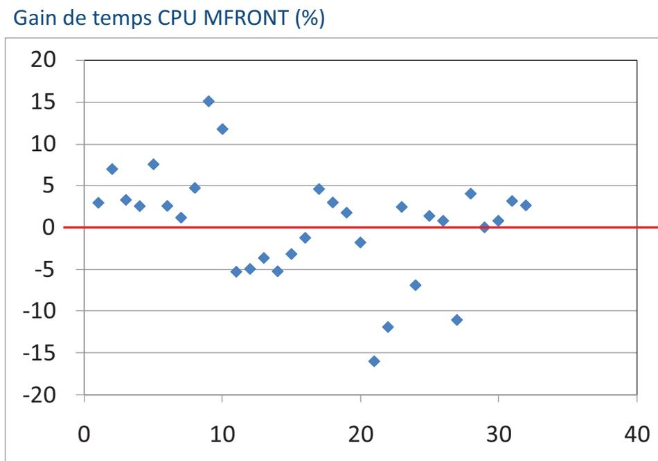
**FIGURE 1 :** Comparaison des performances obtenues avec l'implantation `mfront` et l'implantation native d'une même loi de comportement viscoplastique orthotrope de gaine. Cette loi est testée sur l'ensemble de la base de validation usuelle de `Cyrano3` (le numéro du cas test est reporté en abscisse).
